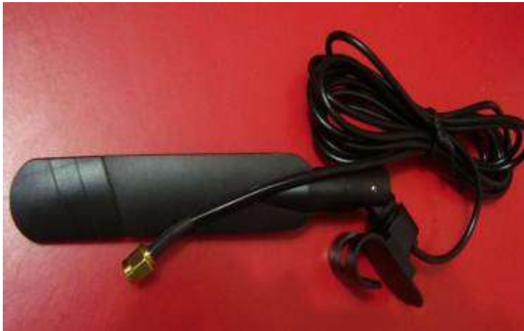
2.1H. ANTENA PALETA DE 9 DBI PARA GSM Y WIFI CON 2 METROS DE CABLE Y ENTRADA 300DE, SMA Y RP-SMA
