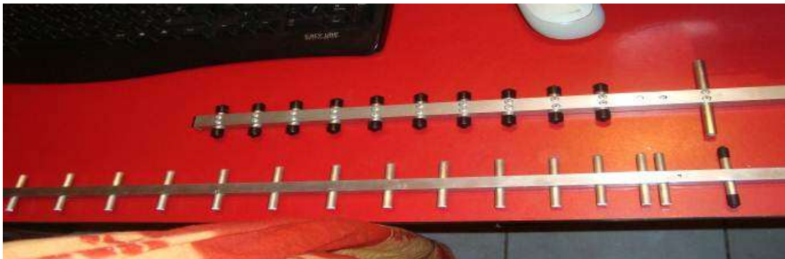
2.1B. COMPARACION DE YAGI WIFI DE 19 ELEMENTOS CONTRA UNA CHINA DEL MISMO ALCANCE
